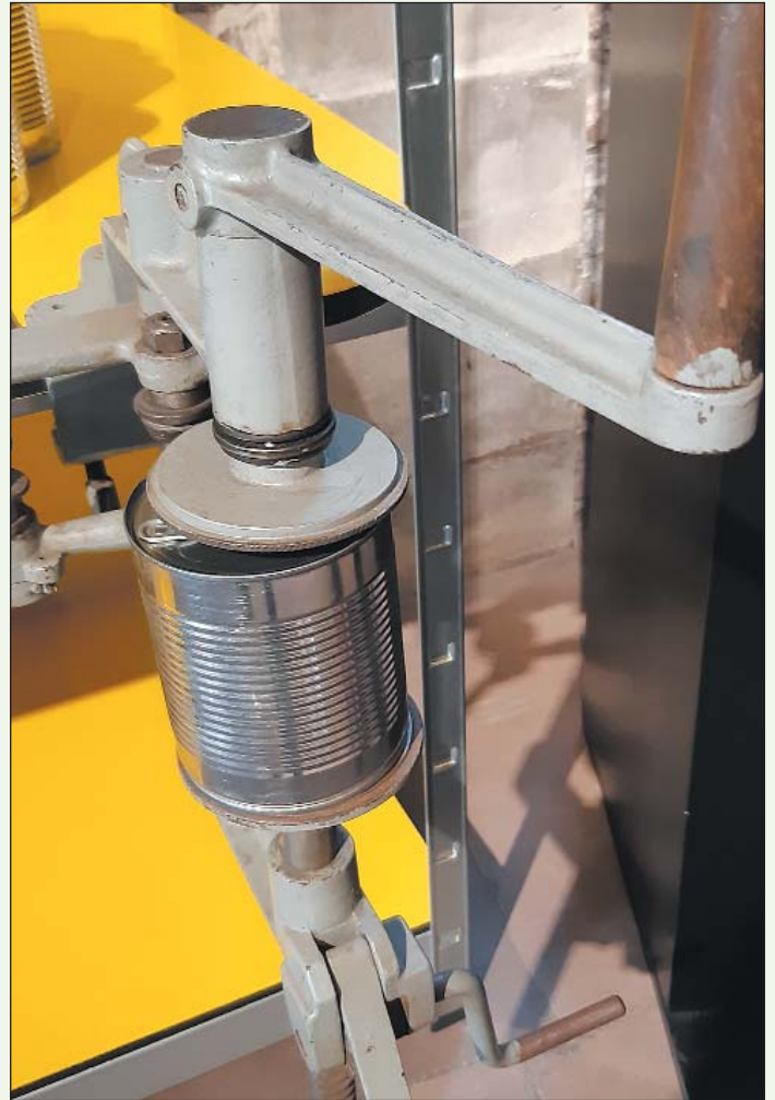
Eine handbetriebene Konservenverschlussmaschine für den Hausgebrauch. Foto: M. Wendler
