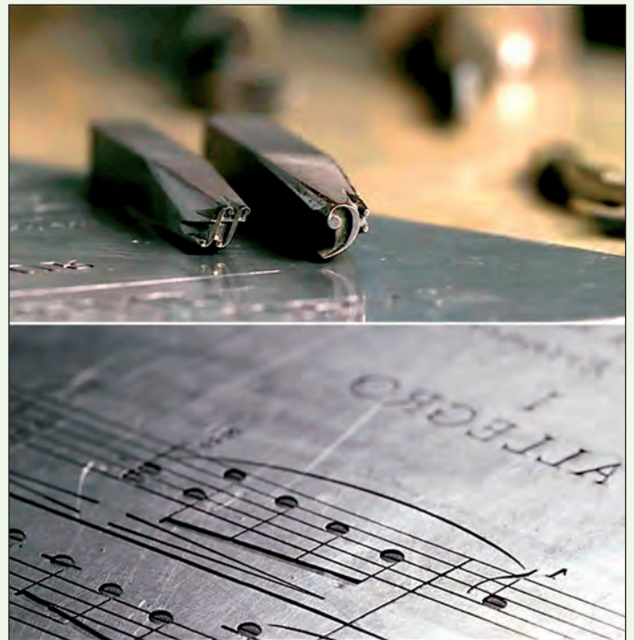
Oben: Stempel für den Notenschnitt. Sie werden mit dem Hammer in eine Zinkplatte geschlagen. Unten: Zinkplatte mit eingeschlagenen Noten.
