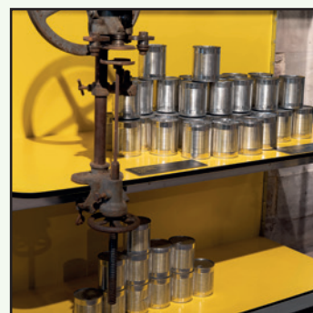
Neue Konservendosen zum Befüllen und Dosenverschlussgerät. Foto: Dirk Israel
